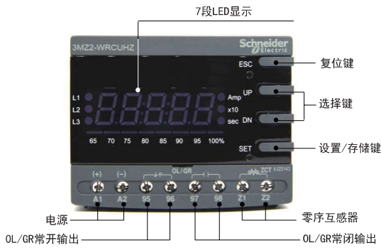
三相电流每2秒循环显示
