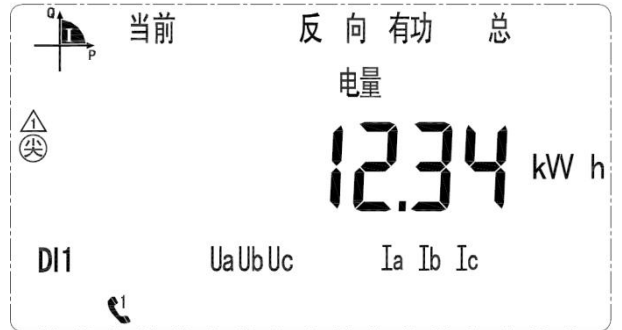
当前反向有功总电量 12.34kWh
