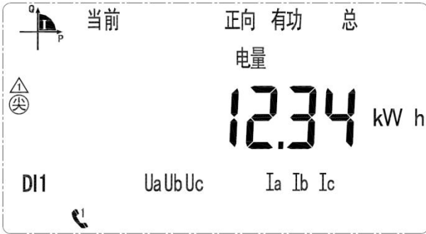
当前正向有功总电量 12.34kWh
