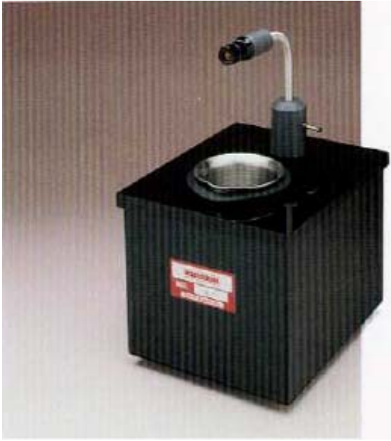
电线（缆）附件 WT: 测量电线的镀层厚度，可测 8—45 号规格电线，也可用于评估金属化合层和其它特殊电线应用。符合 ASTM B-298 和 B-355 标准
