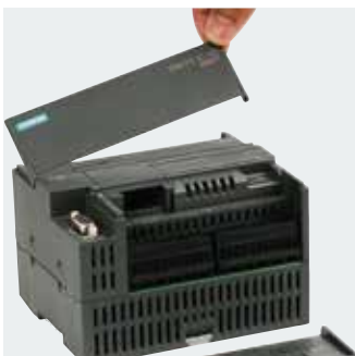
卸掉端子盖板
