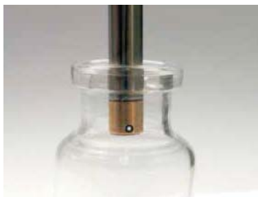
内壁结构测量
