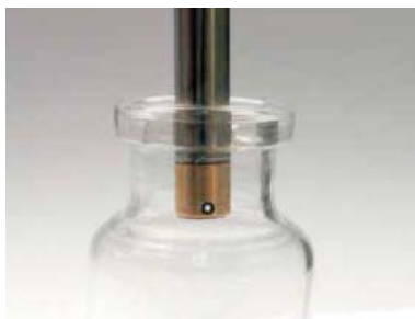
内壁结构测量
